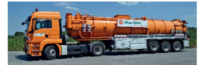
Saugwagen für Bohrschlamm max. Nutzlast 21 t
